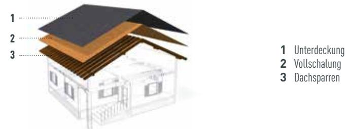
Abbildung 4 • Einschaliger Dachaufbau
