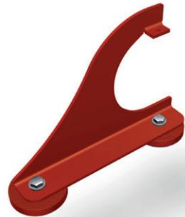
Die Montage erfolgt mit zwei Fußteilen im Dachsparren. In die Gebirgsschneefangstützen können Rundhölzer bis Ø 140 mm eingelegt und mittels den mitgelieferten Schrauben (5 x 60 mm) fixiert werden. Gesamthöhe der Stützen mit Fußteilen: 219 mm. Die Gebirgsschneefangstützen können auch nachträglich montiert werden. Die Montage der Fußteile erfolgt wie beim PREFA Schneerechensystem.
